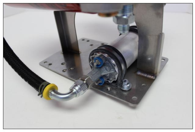
FIGURE 1 – FUEL PUMP MOUNTING & FUEL OUTLET HOSE CONNECTION
